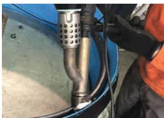
Durch die kompakten Dimensionen sowie dem hohen Ausstoss von bis zu 2 kg/h entsteht ein aussergewöhnlich flexibler Extruder, der in vielen Bereichen einsetzbar ist.
