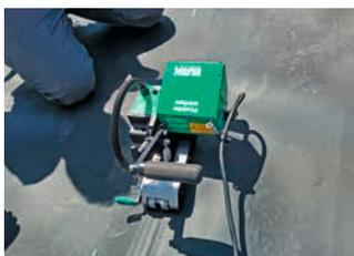
Der kleine und leichte Heizkeil-Schweissautomat zum Verschweissen von allen thermoplastischen Dichtungsbahnen im Tiefbau. Standort der Maschine abrufbar über die myBAK App.
