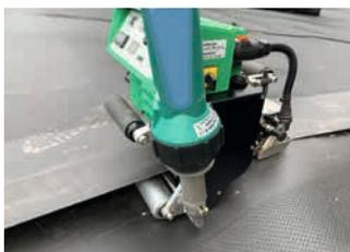
Der starke und schnelle Heizkeil-Schweissautomat mit dem optimalen Preis-Leistung-Verhältnis. Durch den kraftvollen und verschleissfreien Servo Motor ist der ComOn3 für die anspruchsvollsten Baustellen geeignet.
