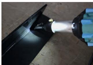
Das leistungsstarke, vollständig in der Schweiz gefertigte, Handgerät zum Verschweissen von thermoplastischen Kunststoffen für Dachdecker, Fußbodenleger, Planenverarbeiter, Kunststoffverarbeiter, usw.
