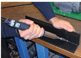
Das Handgerät zum verschweißen von thermoplastischen Kunststoffen für den Kunststoffverarbeiter. Die Luftversorgung erfolgt über ein separates Gebläse (BAK Air Station) oder mittels Pressluft. Die Düse (Heizelementrohr) kann während dem Schweißen 360° gedreht werden.
