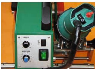
Dank robustem Design ausfallsicher und einfach zu bedienen. Lieferbar für 20, 30 oder 40 mm breite Schweissnähte.
