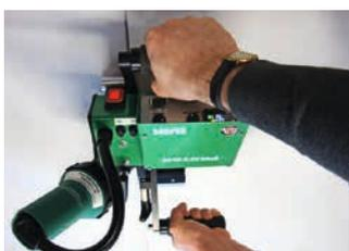
Der kleine und leichte Schweissautomat zum Verschweissen von allen Dichtungsbahnen. Für Tiefbau- und Tunnelanwendungen. Kombikeildüse mit Heissluft und Kontakt. Standort der Maschine abrufbar über die myBAK App.
