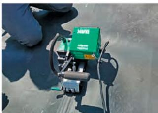
Der kleine und leichte Heizkeil-Schweissautomat zum Verschweissen von allen thermoplastischen Dichtungsbahnen im Tiefbau. Standort der Maschine abrufbar über die myBAK App.
