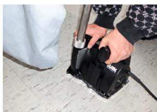
Die zuverlässige Fugenfräse zum staubfreien Fräsen von allen Fussbodenbelägen.
