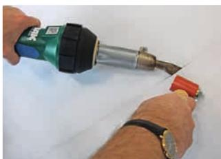
Das leistungsstarke Handgerät zum Verschweißen von thermoplastischen Kunststoffen für Dachdecker, Fussbodenleger, Planenverarbeiter, Kunststoffverarbeiter und viele mehr.
