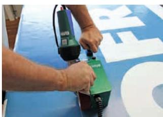
Das kostengünstige angetriebene Handgerät. Schliesst die Lücke zwischen Handgerät und Schweissautomat. Wahlweise für 30 oder 40 mm Schweissnähte erhältlich.
