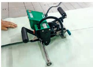
Der kleine und leichte Schweissautomat zum Vorkonfektionieren von dünnen Materialien. Perfekte Schweissnähte mit hoher Schweissgeschwindigkeit. Standort der Maschine abrufbar über die myBAK App.
