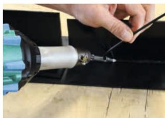
Das leistungsstarke, vollständig in der Schweiz gefertigte, Handgerät zum Verschweißen von thermoplastischen Kunststoffen für Dachdecker, Fussbodenleger, Planenverarbeiter, Kunststoffverarbeiter, usw.
