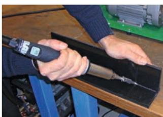
Das Handgerät zum verschweissen von thermoplastischen Kunststoffen für den Kunststoffverarbeiter. Die Luftversorgung erfolgt über ein separates Gebläse (BAK Air Station) oder mittels Pressluft. Die Düse (Heizelementrohr) kann während dem Schweißen 360° gedreht werden.
